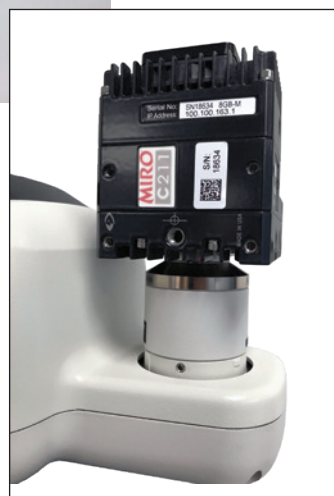
Miro C211 montado en microscopio
