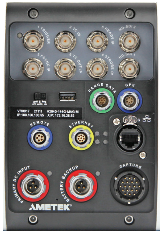
Phantom v1840 y v2640 - Panel trasero
